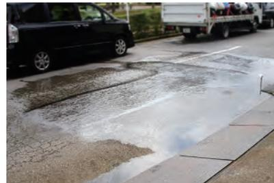
散水面積 2MPaで、横8m X 縦4m
